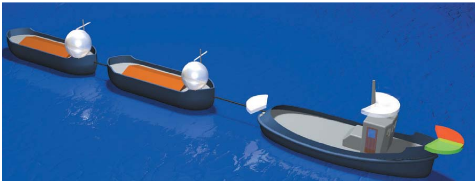
Rys. 10.21. Małe statki w zestawie holowanym lub sprzężonym. Światło: białe widoczne ze wszystkich stron.
