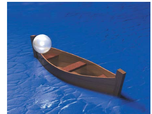
Rys. 10.25. Małe statki bez napędu mechanicznego lub żaglowego. Sygnalizacja nocna. Światło: białe widoczne ze wszystkich stron.
