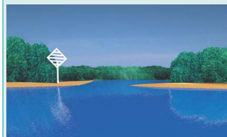
Rys. 5.80. Znak ustawiony z lewej strony wyjścia szlaku żeglownego z jeziora lub szerokiej drogi wodnej.
