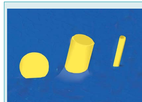
Rys. 5.81. Znaki akwenów zamkniętych dla ruchu żeglugowego.
