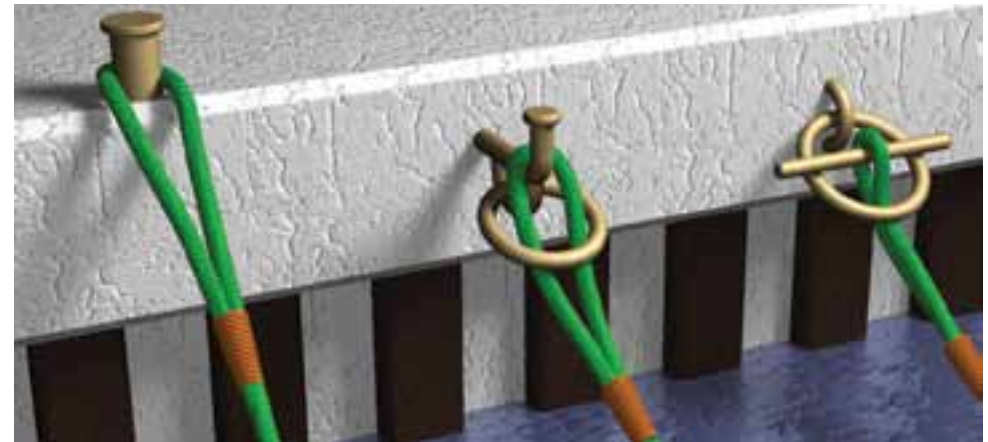
Rys. 10.14. Zakładanie cum zakończonych pętlą.
