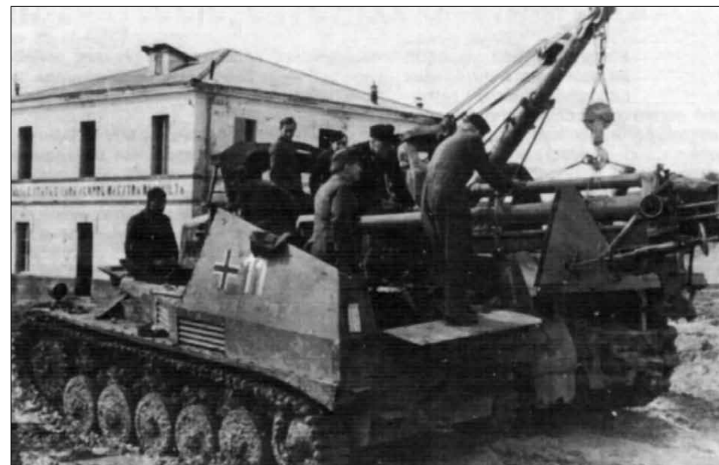
Demontaż haubicy leFH 18/2 kal. 105 mm stanowiącej uzbrojenie dział samobieżnego Sd.Kfz. 124 Wespe.
